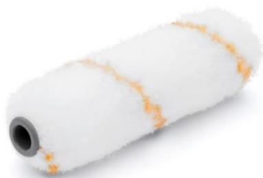
*Figura 15: Rodillo de poliamida con el exclusivo tejido PaNoloss, altura de pelo de 11-13 mm. Ideal para recubrimientos de alta viscosidad.*
