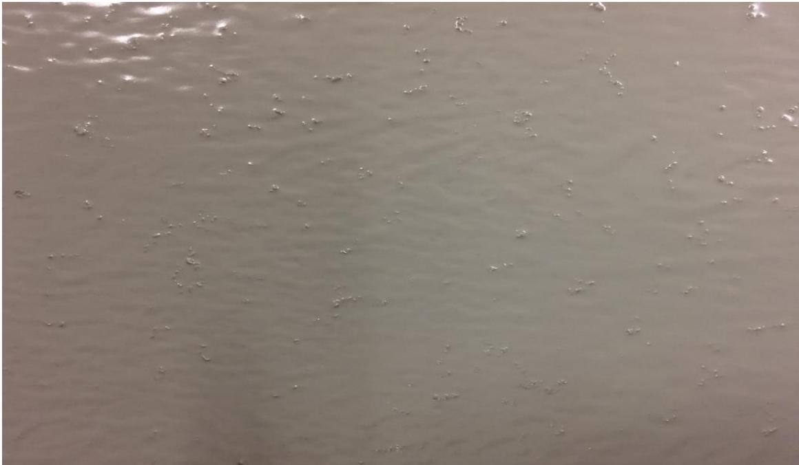
*Figura 4: La pérdida de fibra en la película de recubrimiento desde el rodillo puede crear una vía para que la humedad llegue al sustrato.*
